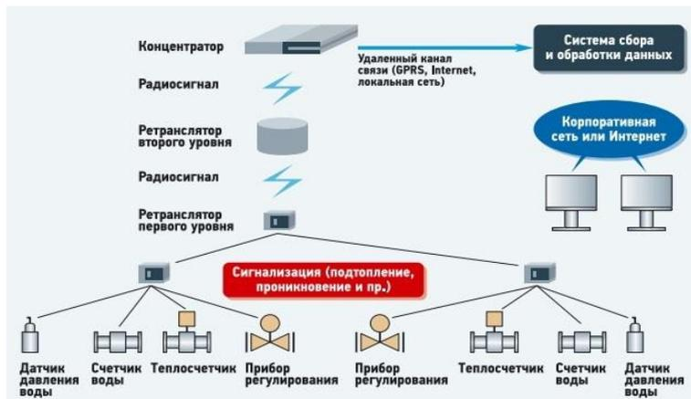
Рис. 1 Структурная схема модели автоматизированной системы анализа качества и энергоэффективности теплоснабжения [2].
