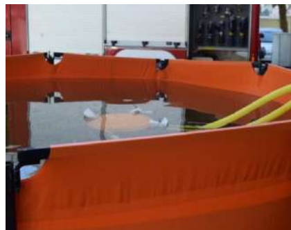
Рис.4. Общий вид подводного устройства при погружении в каркасный резервуар
