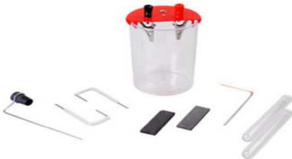
Рис. 3. Пластиковый контейнер для процесса электролиза
