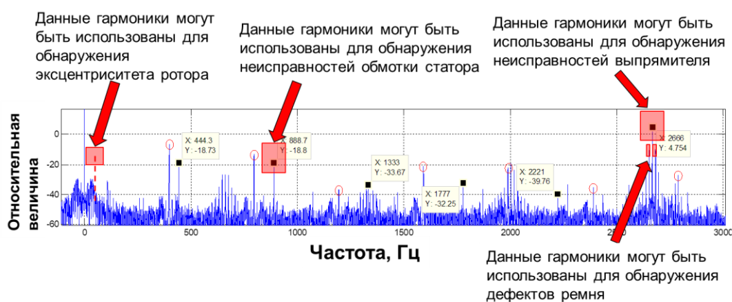
Рисунок 3 - Результаты спектрального анализа напряжения генератора
