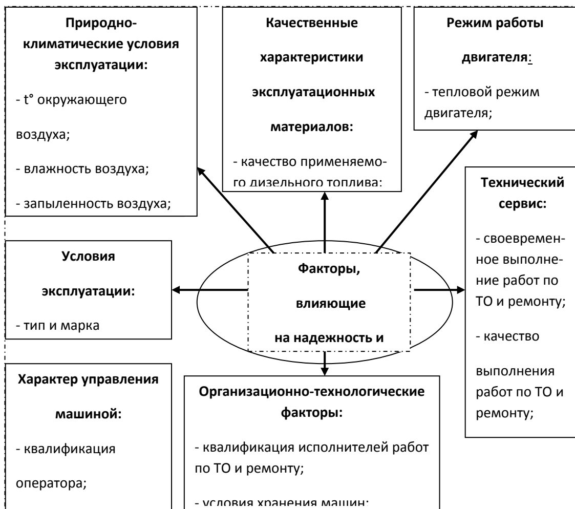
Рисунок 1 - Классификация факторов, влияющих на надежность и эффективность использования дизельного ДВС
