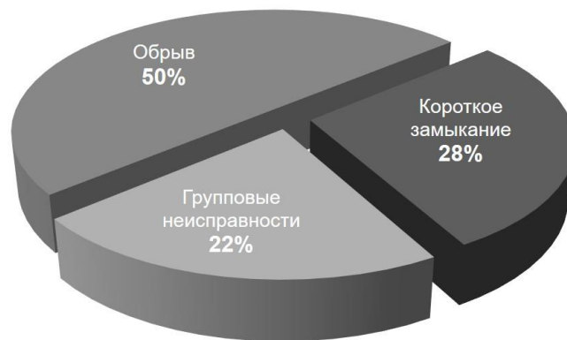
Рисунок 1 - Неисправности выпрямителей автомобильных генераторов
