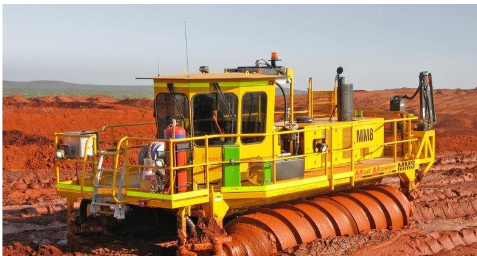
Рисунок 4 - Шнекоход Mud Master, от австралийской компании Residue Solutions
