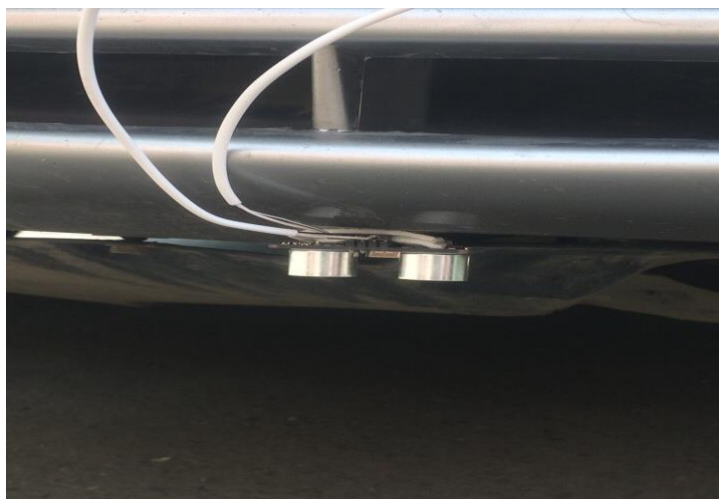
Рисунок 3 – Место установки одного ультразвукового датчика
