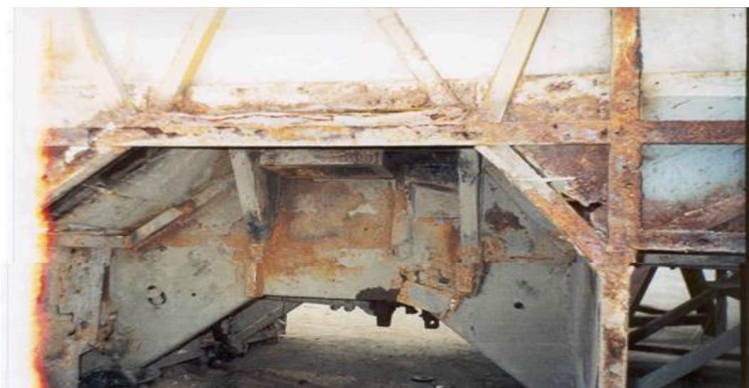
Рисунок 3 - Коррозионно-усталостные разрушения продольного бруса надколесной ниши автобуса «Икарус-280»
