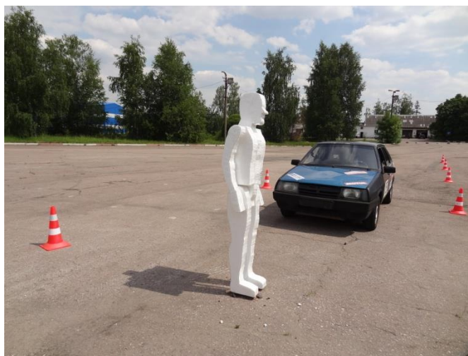
Рисунок 4 - Пенопластовый манекен, прикрепленный к основанию перед проведением испытательного заезда
