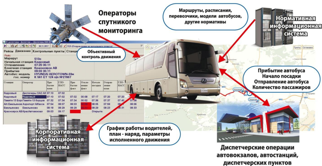
Рисунок 3 - Принципиальная схема интегрированной системы диспетчерского управления перевозками BusTrafficControl
