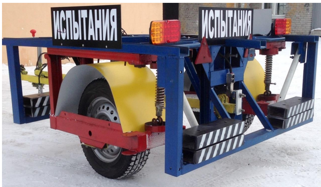
Рисунок 3 - Внешний вид шинного тестера для экспериментального исследования сцепных свойств автомобильных шин с дорогой
