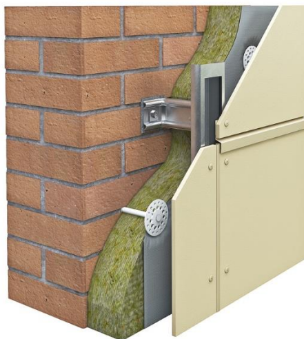
Рис. 1. Схема устройства вентилируемого фасада
