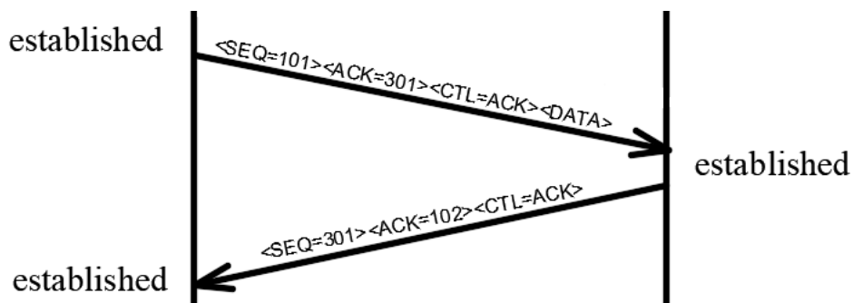
Рис. 2. Временная диаграмма передачи данных протокола TCP.
