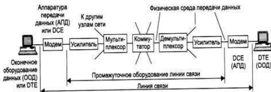
Рис.1. Структура передачи сигналов по линиям связи.
