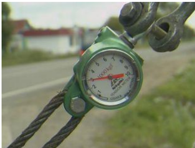
Рис. 4. Крепление на опоре лебедки с динамометром и тендером.
