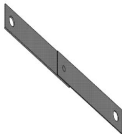
Рис.2. Форма и размеры пробы для оценки адгезионной прочности точно-сварочного соединения.
