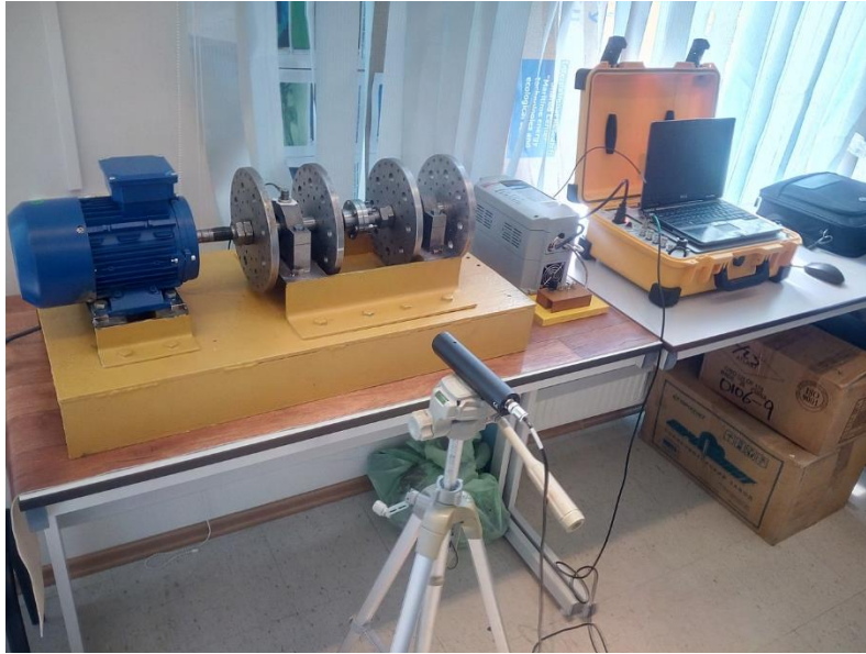
Рис. .3. Экспериментальный стенд с ротором на подшипниках качения.
