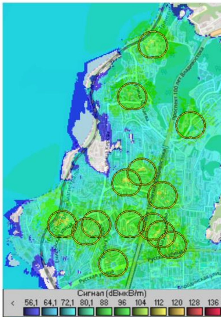
Рис. 1. Моделирование уровня сигнала БС LTE на совмещенном канале.
