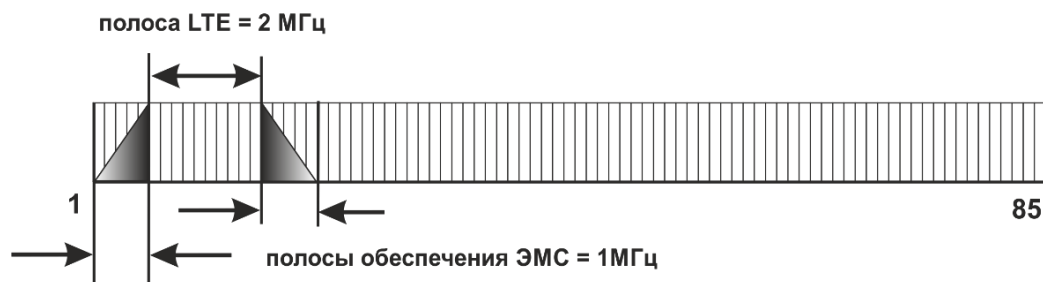
Рис. 4. Ёмкость полосы частот, занимаемой в DCS стандартом LTE в 2 МГц.
