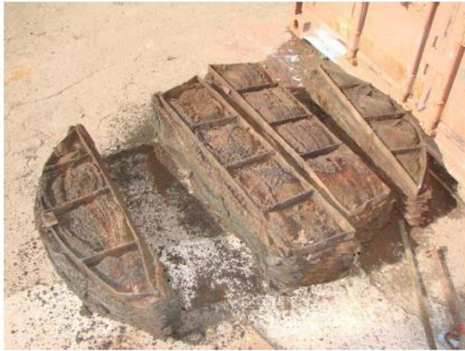
Рис. 1. Коалесцирующий фильтрующий элемент сетчатого типа, извлеченный из сепаратора после 2-х лет работы [5].
