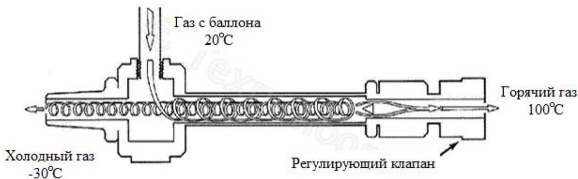
Рис. 2. Схема двухпоточной вихревой трубы.
