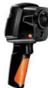
Рис.к 3. Фото тепловизора Testo 872
