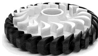
Рис. 3. Фотография базовой ступени турбинного привода
