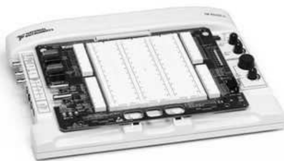
Рис. 1. Учебно-испытательный стенд ELVIS 2
