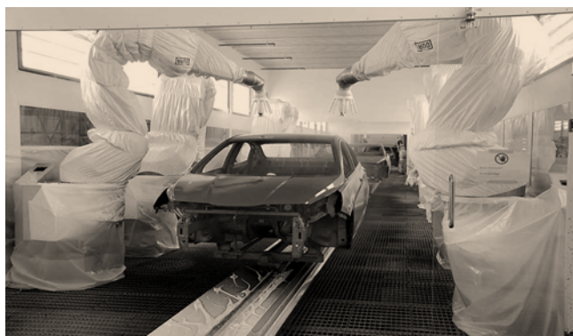
Рис. 3. Робот для покрасочных работ
