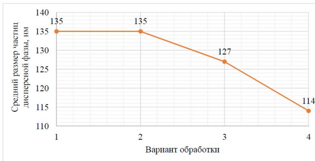
Рис. 2. Зависимость среднего диаметра частиц дисперсной фазы в мазуте от варианта обработки 1 – исходный мазут, 2 – УЗ (мощность 30 Вт), 3 – УЗ (мощность 70 Вт), 5 – УЗ (мощность 100 Вт)
