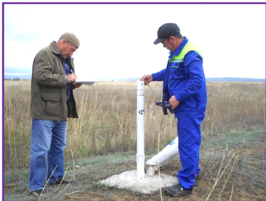
Фото 3 – выполнение специалистами проектной группы совместно с представителями фермерских хозяйств СПК замеров уровня и отбор проб грунтовых вод
