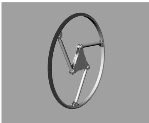
Рис.3. Конструкция SOFTWHEEL колеса и амортизатора
