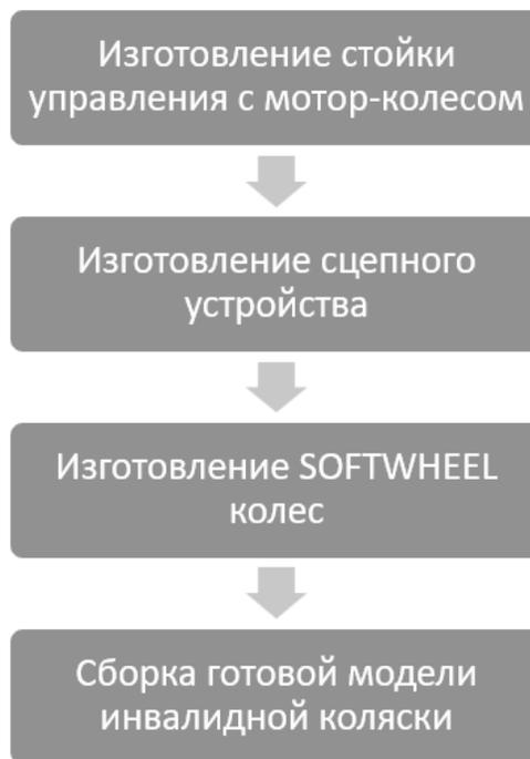
Рис. 1. Этапы производства инвалидной коляски с мотор-колесом.
