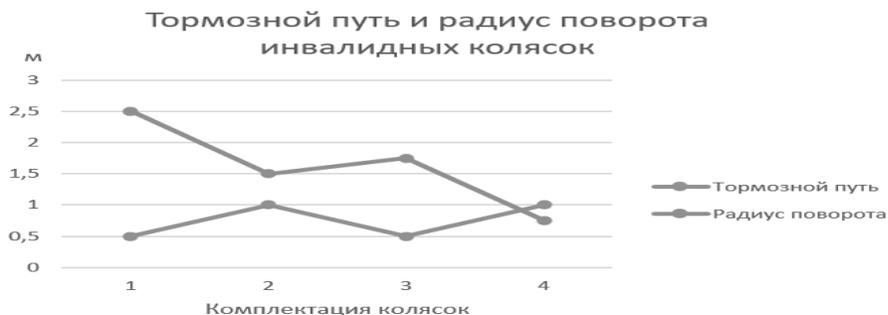
Рис. 6. Радиус поворота и тормозной путь инвалидных колясок различных комплектаций
